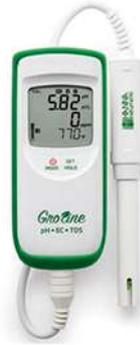
Medidor Portátil e Impermeable de pH/CE/TDS de la Línea Groline, Útil para Hidroponía HI9814
